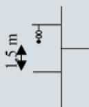
b. Para armados con crucetas tipo bóveda o similares, la distancia mínima entre la cabeza del fuste y la grapa de suspensión de la fase central o puente de unión, no será inferior a 0'88 metros. Esta distancia podrá ser inferior siempre y cuando se cubra con material aislante eficaz los elementos en tensión de la fase central, hasta 1 metro a cada lado del apoyo.
