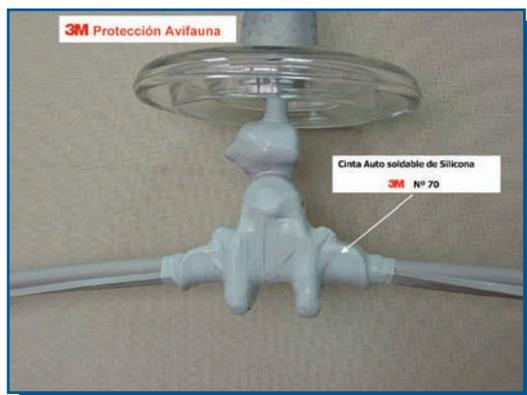
Se aplica en frío, puede hacerse sobre el compuesto anterior, es de silicona y auto-soldable, por su composición es hidrófuga y muy resistente a agentes externos de alta contaminación, ya sea salina o industrial.
