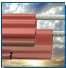
Un canal para 15 KV (**OLIC-O**) y otro para 24 KV (**OLIC-C**) diseñados para colocarse sobre conductores desnudos desde 4 a 25 mm para evitar disparos de la línea por contactos intermitentes causados por ramas, aves y otros animales evitando la mortandad de estos por electrocución.
