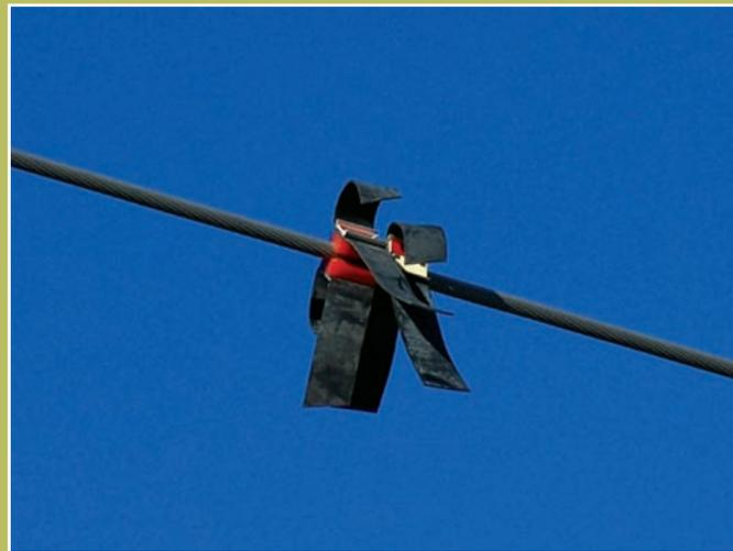
*Espiral cerrada de polipropileno deteriorada por efecto del viento.*
